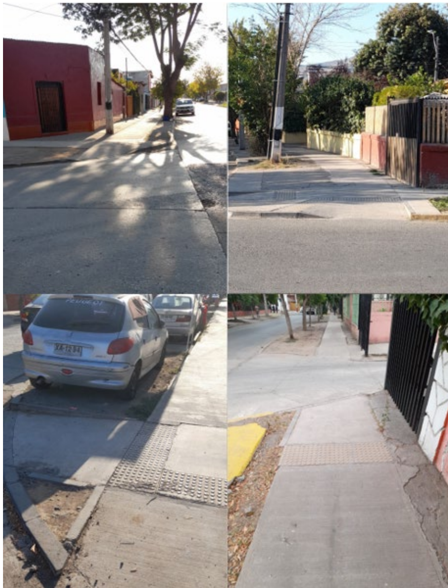
Figura 6. Algunos resultados del impacto del Programa de Pavimentación Participativa en la comuna de Recoleta (Población Angela Davis). En las cuatro imágenes podemos observar la instalación del nuevo estándar en las veredas y en los rebajes de veredas.
